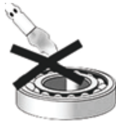
Figura 28 – Exemplo de aquecimento incorreto
