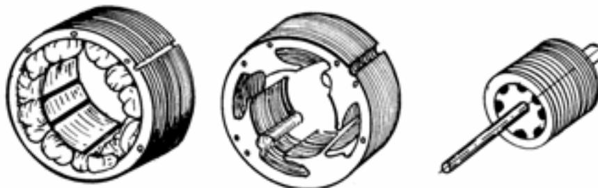
Uma vez que, no motor de campo distorcido, o rotor é do tipo gaiola de esquilo, todas as ligações encontram-se no estator. Veja representação esquemática dessas ligações na Figura 23.
