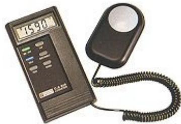
Em instalações recém-construídas, deve-se fazer as lâmpadas funcionarem por algum tempo (aproximadamente 100h), para que sejam devidamente sazoadas e estabilizadas em seus fluxos luminosos. Só depois se processam as medições.
