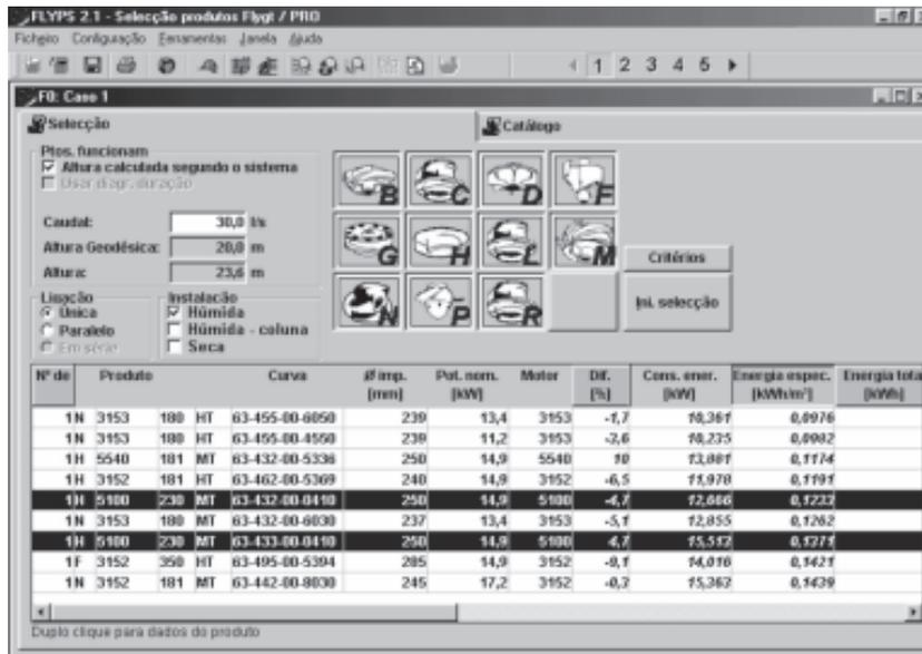
Figura II.11: Opções de bombas oferecidas pelo software
