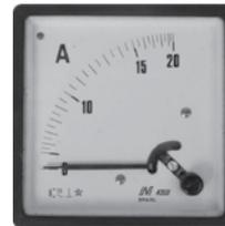
Instrumento destinado a medir a corrente elétrica.
