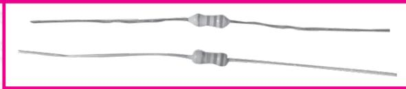
Dispositivo cuja resistência ao fluxo da corrente elétrica tem um valor conhecido e determinado.
