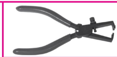
Tem como função remover a isolação de fios e cabos.
