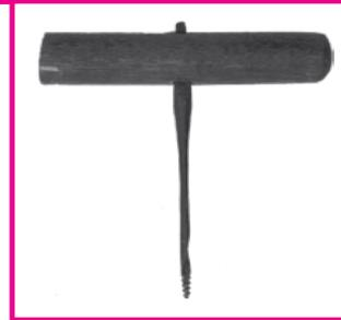
Ferramenta manual em forma de broca utilizada para preparar furos destinados a parafusos.
