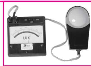
Instrumento utilizado para medir iluminância, ou seja, a energia luminosa recebida por unidade de superfície.
