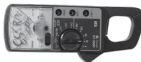
Instrumento que tem como função principal medir correntes alternadas e contínuas, permitindo que se efetue a medição sem que seja necessária a abertura do circuito.
