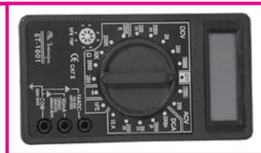
Tipo de dispositivo eletroeletrônico usado para medir corrente contínua, corrente alternada, tensão e resistência.
