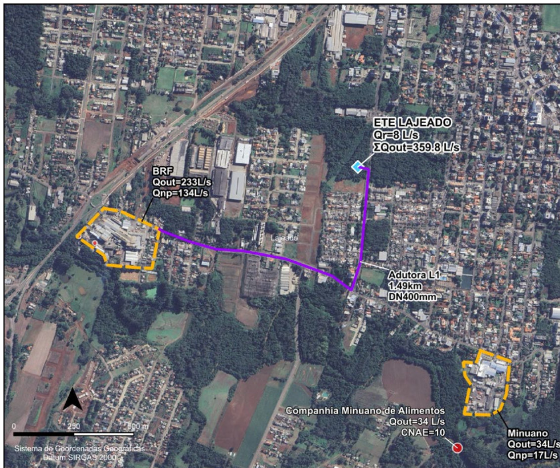
FIGURA 8 – Estudo de caso #2 – arranjo esquemático do sistema de produção e distribuição de água de reúso para abastecimento da BRF em Lajeado
