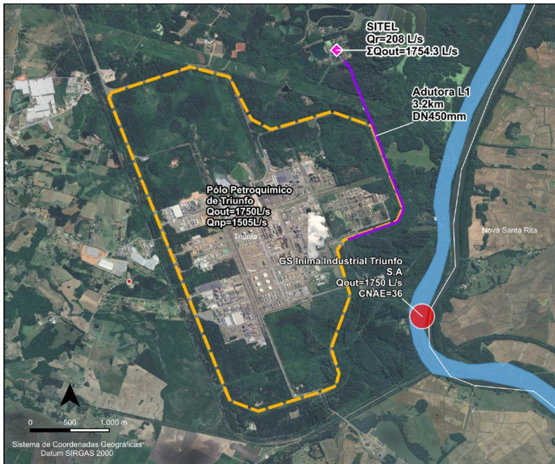
FIGURA 6 – Estudo de caso #1 – arranjo esquemático do sistema de produção e distribuição de água de reúso para abastecimento da Polo Petroquímico de Triunfo a partir do SITEL
