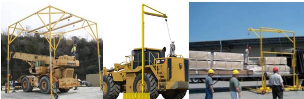
Figura 33 - Estruturas Móveis para Proteção Contra Queda
