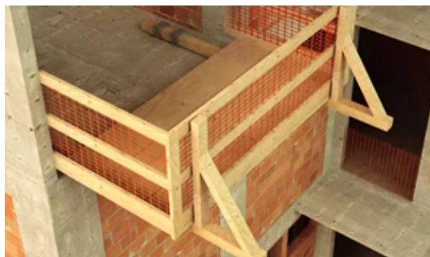
Figura 16 - GcR em Plataforma em Balanço
