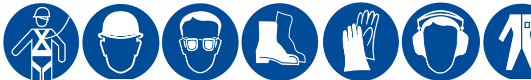
Figura 78 - Equipamentos de Proteção Individual para Trabalhos em Cadeira Suspensa
