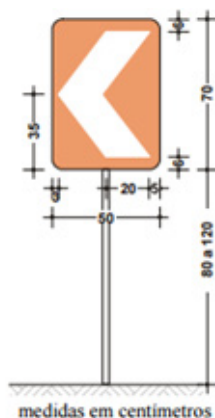
Figura 170 - Exemplo de Marcadores de Alinhamento
