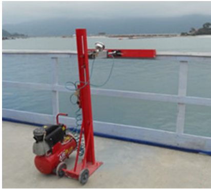
Figura 14 - Testes em Guarda-Corpo
