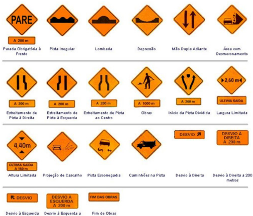
Figura 165 - Sinais de Advertência para Motoristas em Obras
