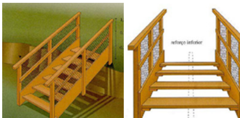
Figura 13 - Guarda-Corpos de Escadas de uso Coletivo
