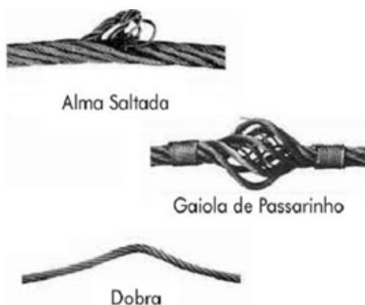
Figura 83 - Defeitos em Cabos e Aço
