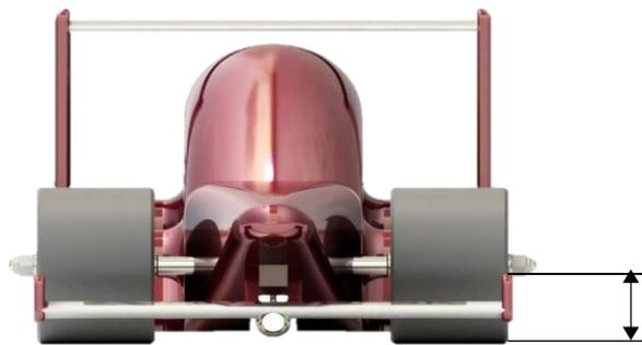
**T8.7:** Visibilidade da vista frontal fisicamente obstruída até uma altura máxima de 15.0mm
