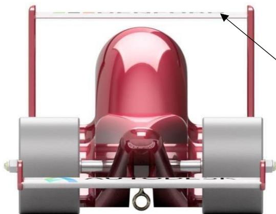
**T10.7:** Visibilidade da asa traseira não obstruída fisicamente na vista frontal
