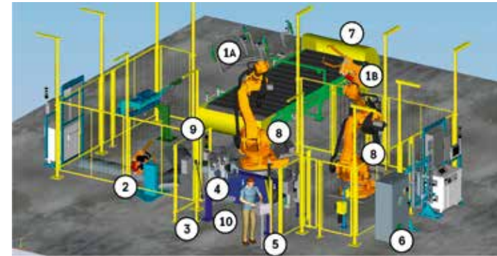
Figura 3: Equipamentos reais da célula de soldagem robotizada baseada em comissionamento virtual
