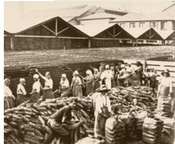
Na fábrica de vidro Santa Marina, enquanto as mulheres enrolavam, uma a uma, as garrafas em palha para depois colocá-las em sacos, os homens trabalhavam dentro da fábrica, junto aos fornos, amarrados a correntes de ferro para não correrem o risco de cair. Nos anos 1950, a Santa Marina foi comprada pela poderosa multinacional Saint Gobain.
