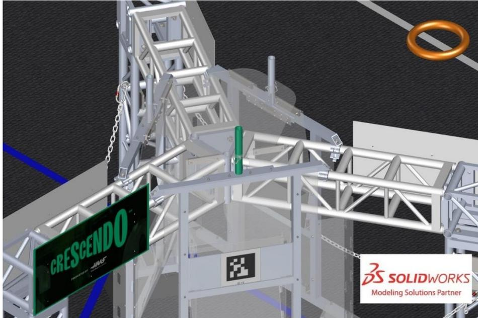
Um PÓDIO é um painel de PEAD (Polietileno de Alta Densidade) na cor da ALIANÇA fixado na coluna do PALCO virada para a PAREDE DA ALIANÇA. Cada PÓDIO tem 1 pé 5¾ pol. de altura por 10 pol. de largura (~45 cm por ~25 cm) e é montado logo acima do pé da treliça.
