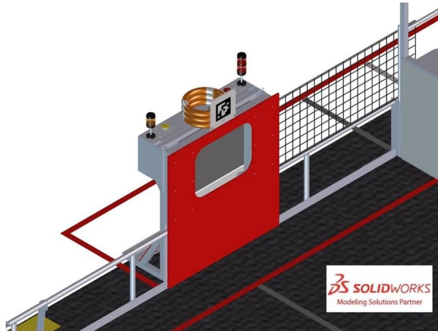
Um AMPLIFICADOR é uma estrutura usada pelos ROBÔS para passar NOTAS para a ÁREA DA ALIANÇA. Há 1 AMPLIFICADOR por ALIANÇA. Cada AMPLIFICADOR tem um compartimento vertical com  $3\frac{3}{8}$  pol. de profundidade (~10 cm), 1 pé e 6 pol. de altura (~46 cm) e 2 pés de largura (~61 cm). A parte inferior do compartimento está a 2 pés 2 pol. (~66 cm) do carpete. Cada AMPLIFICADOR está a 4 pés e  $1\frac{1}{2}$  pol. (~126 cm) da PAREDE DA ALIANÇA mais próxima.
