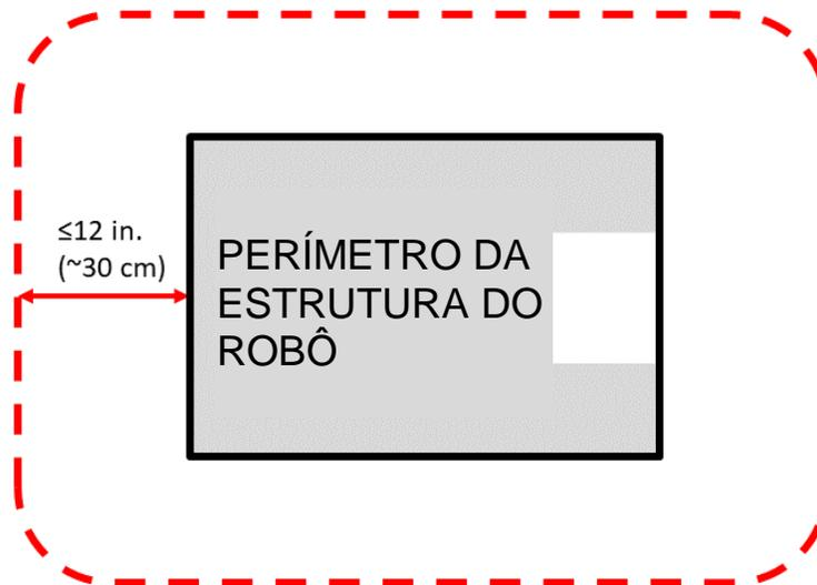
As equipes devem estar preparadas para demonstrar a capacidade do ROBÔ de restringir suas dimensões durante a inspeção de acordo com o exposto acima. As restrições podem ser implementadas através de hardware ou software.
