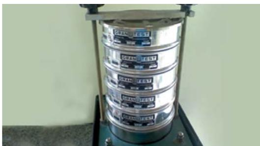
Figura 5: Equipamento utilizado para determinação da granulometria
