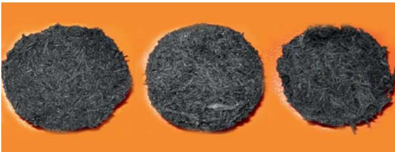
Figura 8: Comparação entre as amostras utilizando a cola I, II e III
