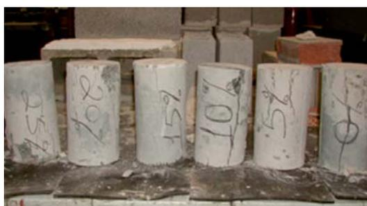
Figura 12: Corpos de prova após o teste de resistência
