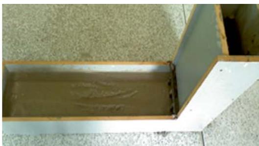
Figura 13: Vista lateral da caixa em L
