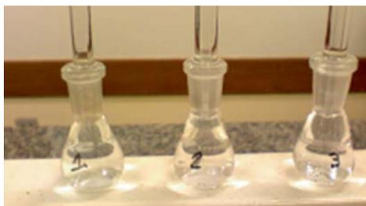
Figura 4: Picnômetros para determinação da densidade
