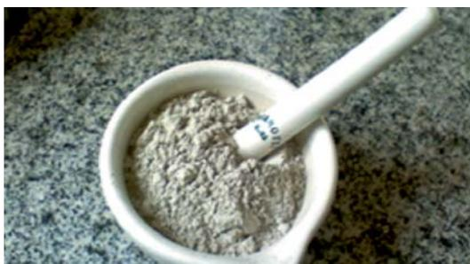
Figura 3: Processo de apiloamento
