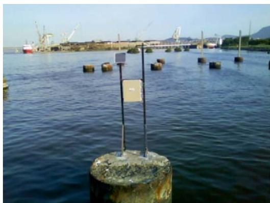
Figura 4: Sistema ondaleta instalado nos pilares paralelo ao cais
