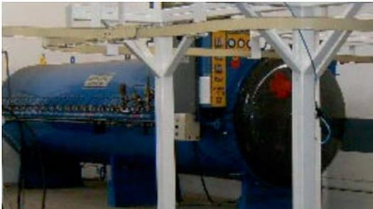
Figura 4: Autoclave utilizado pela empresa para vulcanização
