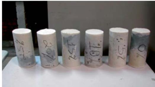
Figura 7: Corpos de prova antes do teste de tensão
