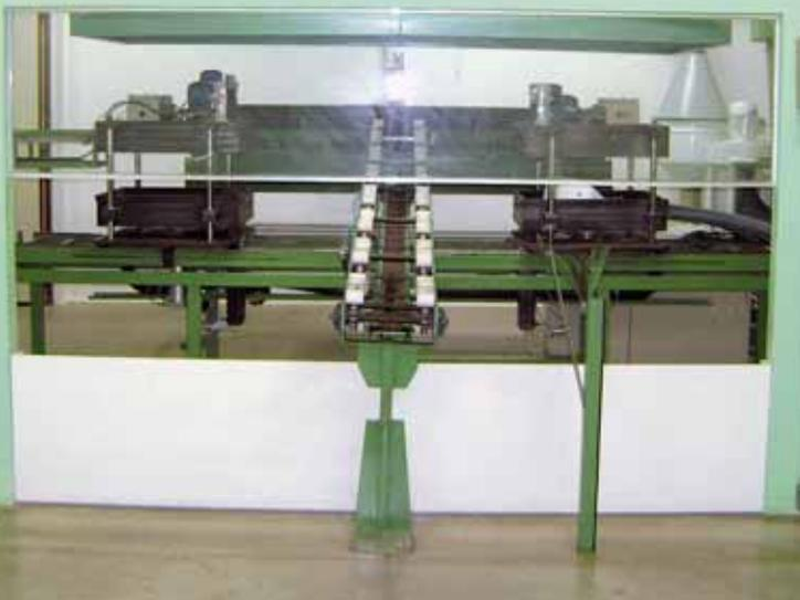
Equipamento de descontaminação de lâmpadas fluorescentes da empresa Tramppo Recicla
