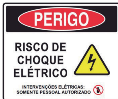
Figura 2 – Exemplo de sinalização para quadro ou painel de comando e potência
