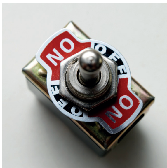
Figura 3 – Interruptor do tipo alavanca de duas posições com retenção de posição
