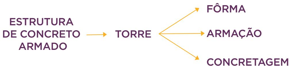
Figura 58. Quebra da estrutura do edifício em partes para orçamentação.
