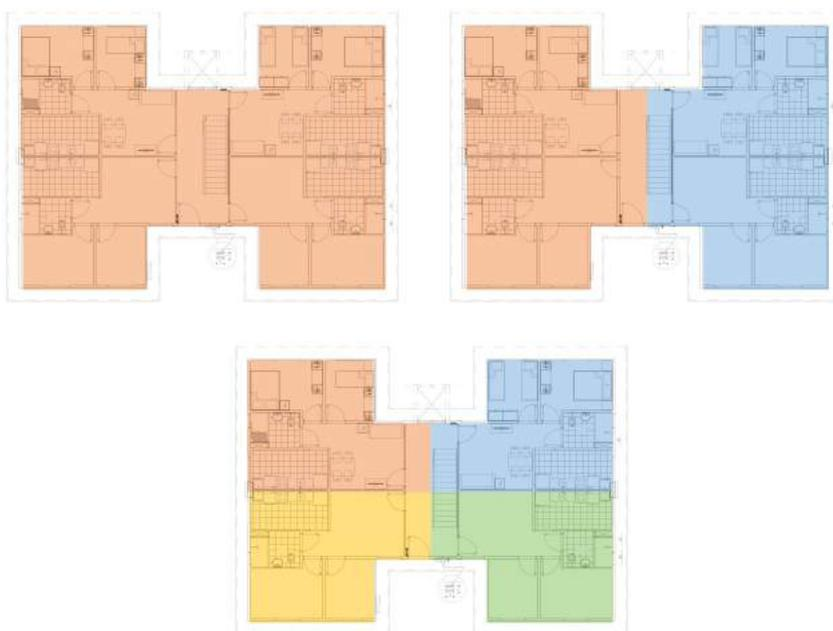
Figura 50. Divisão da estrutura do pavimento tipo em “partes”.
