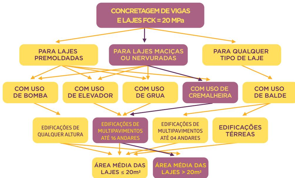
Figura 21. Exemplo de aplicação da árvore de fatores para concretagem de vigas e lajes.
