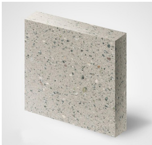
FIGURA 14 – Imagem do Revestimento Cimentício Lixado.
