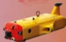
Flatfish, robô 100% autônomo para inspeção submarina de dutos de petróleo.
