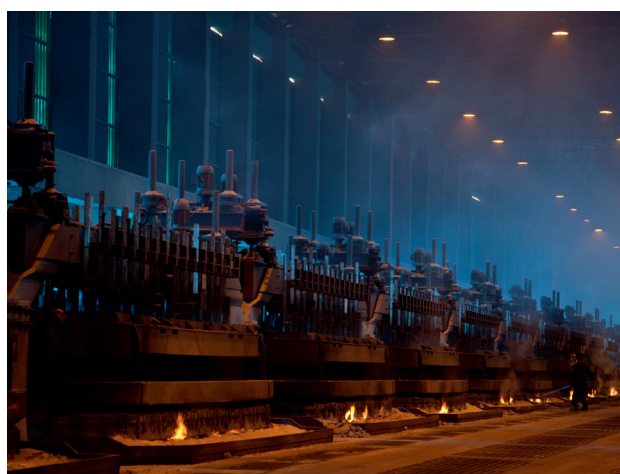
Figura 4 - Linha de cubas eletrolíticas que podem ser alimentadas com o alucoque.
