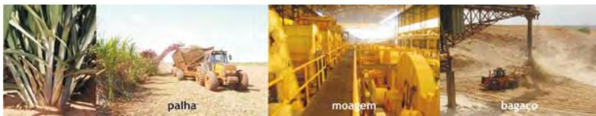
Como mostram as figuras seguintes, o bagaço é queimado para produzir vapor e energia elétrica, utilizados no processo de produção de açúcar e álcool.
