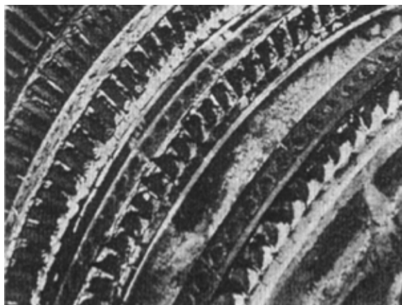
Figura 19 - Os depósitos nas lâminas da turbina reduzem a eficiência.
