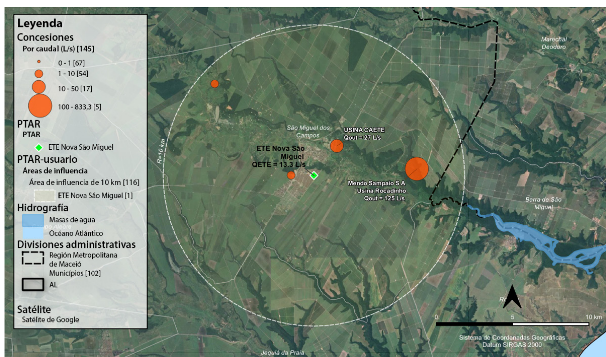
FIGURA 12 – Ejemplo de aplicación del método PTAR-usuario para el caso de la PTAR Nova São Miguel, en São Miguel dos Campos
