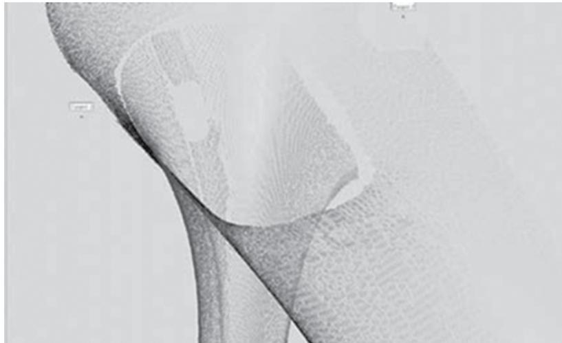
Uma vez obtida a nuvem de pontos, a mesma pode então ser utilizada diretamente em modelagem mista, expressão que designa a redefinição computacional das superfícies do objeto físico a partir dos pontos digitalizados. Esse processo requer a permanente intervenção do operador do sistema e muitas vezes é bastante demorado.
