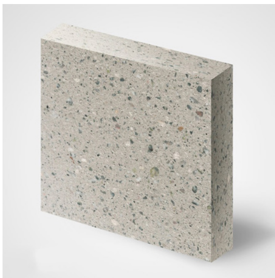
FIGURA 19 – Imagem do Revestimento Cimentício Lixado
