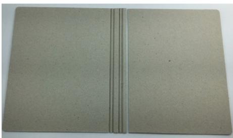
Imagem – 2: Ranhura e extração de material no papelão formando 04 canaletas paralelas.
