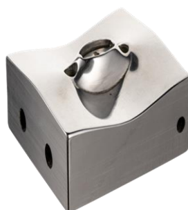
Figura 40 - Inserto de molde impresso em aço para injeção de bocais de inaladores médicos
