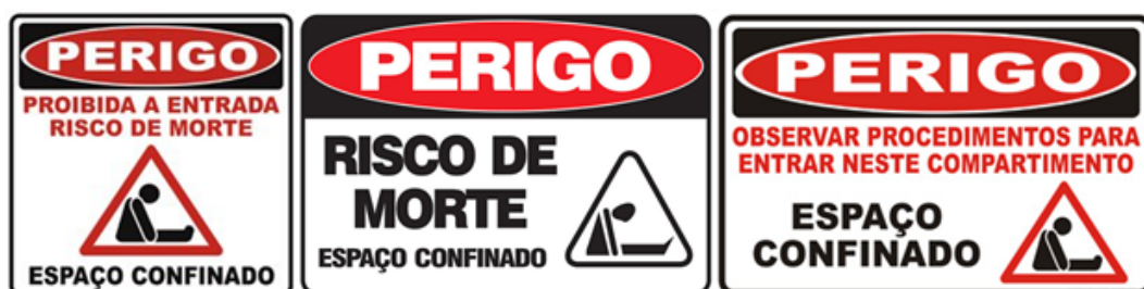
Figura 111 - Sinalização de Local Confinado
