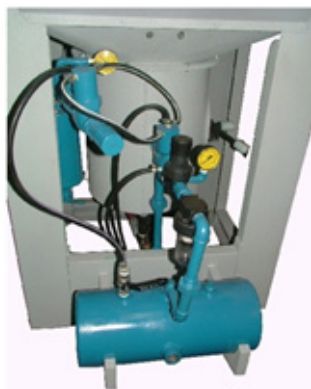
Figura 35 - Bomba de Jateamento
