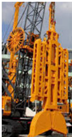
Figura 22 - Perfuradora de Parede Diafragma
